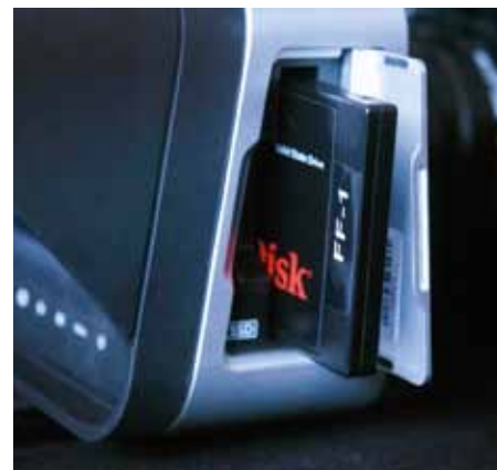
SSD-disken skjuts in från sidan.
